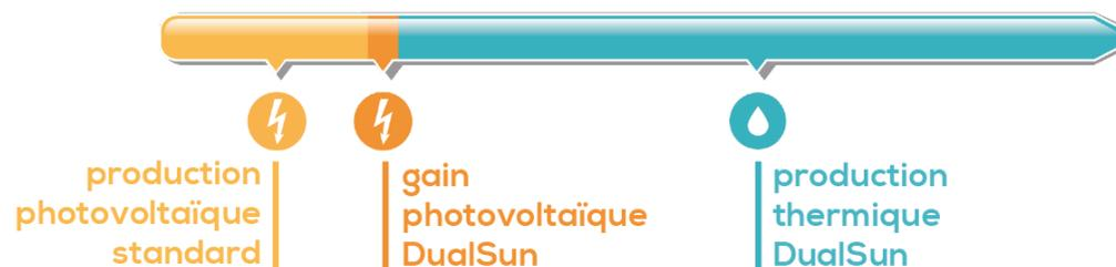
5 à 15 % d'électricité en plus grâce au refroidissement des cellules photovoltaïques :
